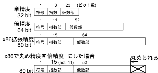
図 1: 浮動小数点数の表現形式と x86 の丸め精度
